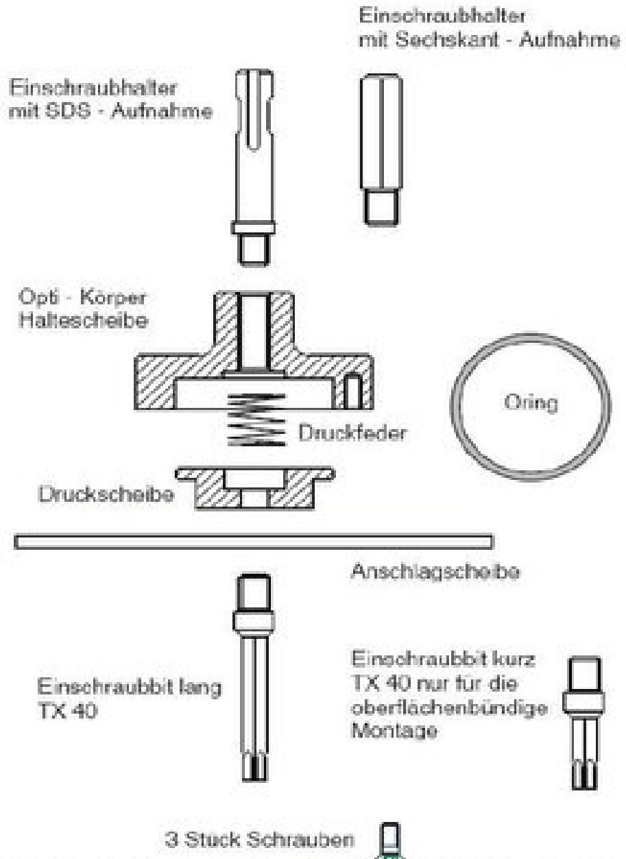
Bei der oberflächenbündigen Montage wird die Druckscheibe und die Druckfeder entfernt, der Einschraubbit kurz wird danach wieder eingesetzt.
