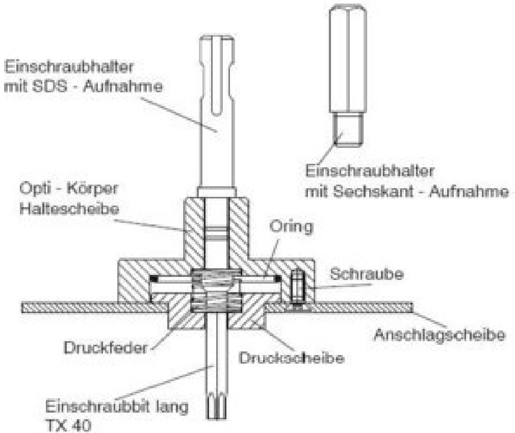
Für die oberflächenbündige Montage ist die Druckscheibe und Druckfeder sowie der Oring (wenn vorhanden) zu entfernen. Der lange Einschraubbit ist durch den kurzen Bit zu ersetzen.
