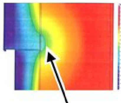
Sockelprofile aus Aluminium stellen eine starke Wärmebrücke dar, die sich um das ganze Haus zieht!
