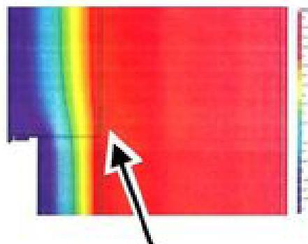
Baumit SockelProfil **therm** stellt aufgrund der geringen Wärmeleitfähigkeit keine Wärmebrücke dar.
