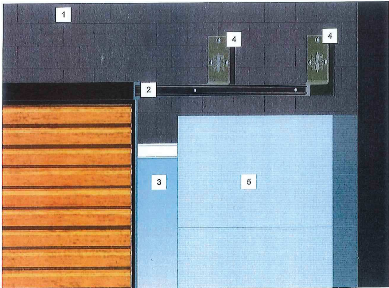
Darstellung 1: Beispiel Einbauzustand Schiebeladen – stirnseitige Montage
