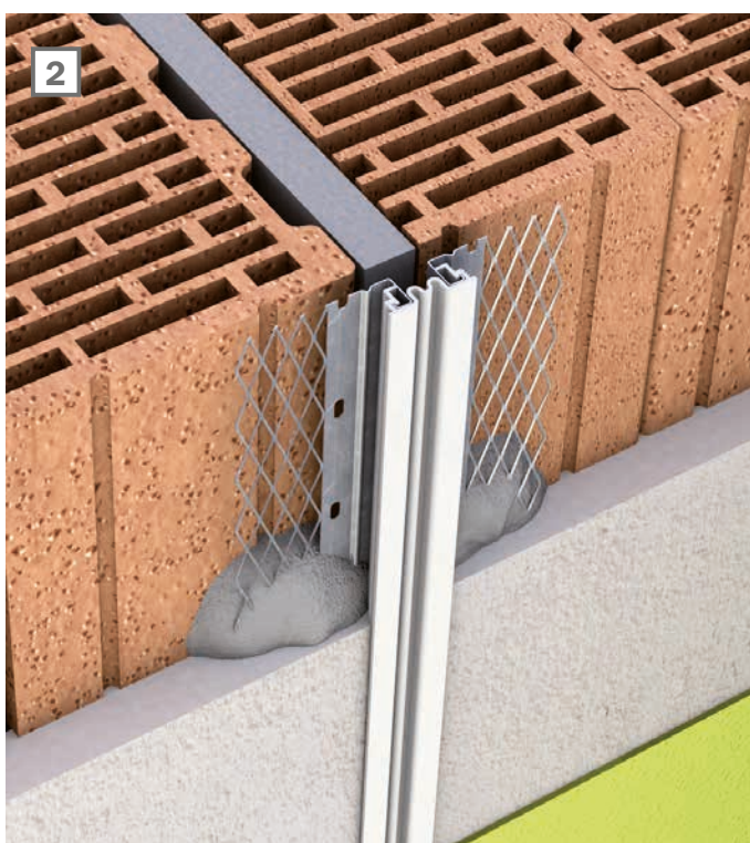
Dehnungsfugenprofil Wand mit Kalkzementputz
