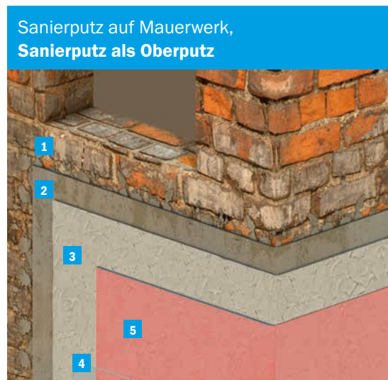
Sanierputz auf Mauerwerk, Oberputz kein Sanierputz-WTA
