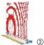
Selbstklebende Hart-PVC-Leiste mit komprimiertem PUR-Dichtband und Gewebe, zur Abdichtung und Entkopplung von Anschlussfugen an Fenster- und Türrahmen, bei denen mit Ausgleichsbewegungen gerechnet werden muss, weiß. Einsatzbereich: siehe Auswahlkriterien. Geeignet für Armierungsschichtdicken 3–6 mm.
