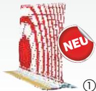
Selbstklebendes Kunststoffprofil mit komprimiertem PUR-Dichtband und Gewebe, zur Abdichtung und vollständiger Entkopplung von Anschlussfugen an Fenster- und Türrahmen, bei denen mit größeren Ausgleichsbewegungen gerechnet werden muss.
