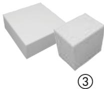
Formgeschäumter Quader aus weiß eingefärbtem EPS mit hohem Raumgewicht. Zur Befestigung von Rohrschellen, Rückhaltern, Kleiderbügelträgern. Kann auch als Druckunterlage eingesetzt werden.
