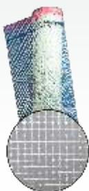
Feines, schiebefestes, alkalibeständiges Textilglas gewebe zum Einbetten in Kleber und Spachtelmassen, systemgeprüft, Reißfestigkeit  $\geq 1,8$  kN/5 cm. Gewicht: ca. 160 g/m<sup>2</sup>
