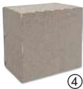
PU MontageQuader aus fäulnisbeständigem und FCKW-freiem PU-Hartschaum. Geeignet als Druckunterlage für höhere Drucklasten an Fassaden. Nicht für die direkte Befestigung von Lasten geeignet.
