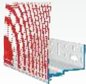
Sockelprofil aus Kunststoff zur Minimierung von Wärmebrücken. Ausführung mit Tropfkante, verschweißtem Gewebe und Steckverbindersystem für hohe Sicherheit gegen auftretende Risse im Stoßbereich. Durch die Steckverbindung lässt sich das Profil auf den Untergrund fixieren und vereinfacht so die Montage.
