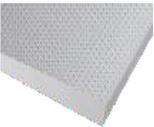
Polystyrol-Dämmplatte nach DIN EN 13163, schwerentflammbar, zugelassen für Anwendung bis 3 m im erdberührten Bereich, Baustoffklasse B1 nach DIN 4102-1, Bemessungswert der Wärmeleitfähigkeit 0,035 W/(mK).
