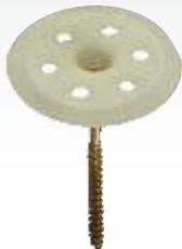
Wärmebrückenoptimierter Tellerschraubdübel für Holzuntergründe. Verankerungstiefe: 30–40 mm. Für Holzuntergründe keine bauaufsichtliche Zulassung für den Dübel erforderlich. Die Verschlusselemente aus EPS sind im Lieferumfang enthalten.
