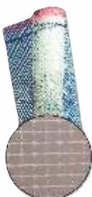
Schiebefestes, alkalibeständiges Textilglasgewebe zum Einbetten in Kleber und Spachtelmassen, systemgeprüft, Reißfestigkeit  $\geq 2,2$  kN/5 cm. Gewicht: ca. 200 g/m<sup>2</sup>
