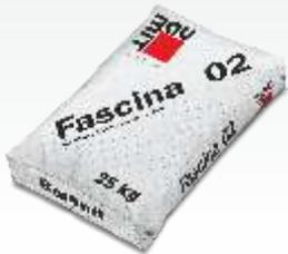
Mineralischer Edelputz, Strukturkorn Marmor, je nach Körnung zum Spachteln, Spritzen, Schlämmen, Abschweißen, Reiben, Strukturieren und Modellieren, vergütet, hohe Abrieb-, Stoß- und Schlagfestigkeit, auch für den Sockelbereich geeignet, für außen und innen, speziell entwickelt als Endbeschichtung für die SuperDämmfassade (open).
