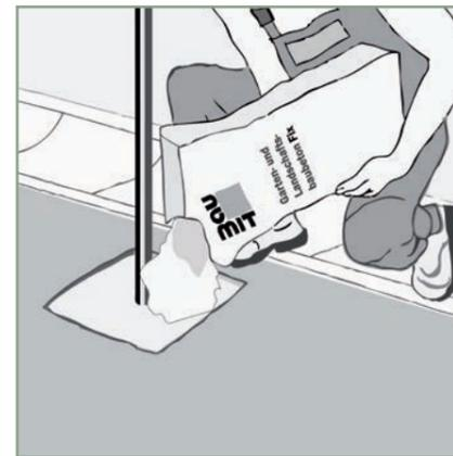
4 Wenn das Loch zur Hälfte gefüllt ist, kann die Zaunsäule eingesetzt und ausgerichtet werden. Anschließend weiter Material auffüllen und durchfeuchten, bis das Loch komplett aufgefüllt ist.
