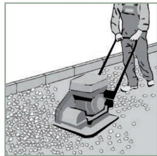
**1** Vor Arbeitsbeginn sind die ausreichende Festigkeit und der frostsichere Aufbau des Untergrundes zu prüfen. Wasserdurchlässiger Untergrund sowie ein eingebautes Gefälle sind Voraussetzung.
