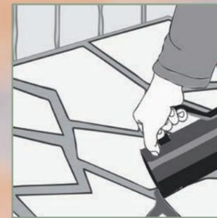
**4** Pflasterfugenmörtel kann in plastischer oder in fließfähiger Konsistenz angerührt werden. Am besten lässt sich das Material in fließfähiger Konsistenz hohlraumfrei in die Fuge einbringen.
