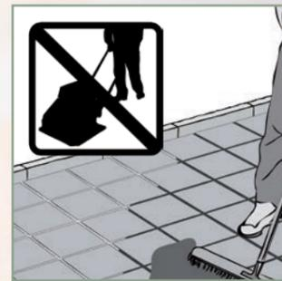
**4** Zum Einbringen des Pflasterfugenmörtels Fix zuvor die Fläche satt anfeuchten und anschließend das Material mit einem groben Straßenbesen fest und verdichtend in die Fugen einkehren. Restmaterial auf den Platten oder Steinen mit einem feinen Besen diagonal zur Fuge abkehren.
