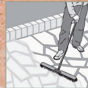
**6** Für die einfachere Vorreinigung kann die frisch mit Pflasterfugenmörtel verfügte Fläche mit Quarzsand abgestreut und mit einem groben Straßenbesen abgekehrt werden.
