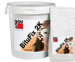
**Prodotto** Collante bituminoso bicomponente, fibrorinforzato, privo di diluenti, per l'incollaggio di pannelli isolanti in EPS e XPS in aree di zoccolatura su impermeabilizzazioni bituminose.
